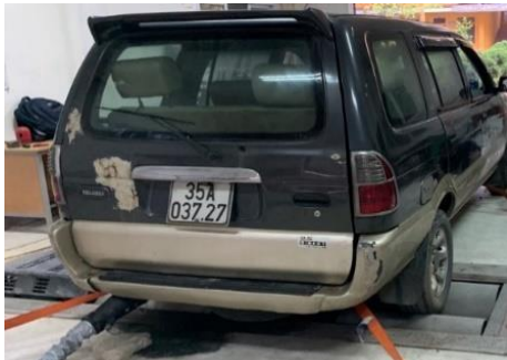
Hình 3. Lắp đặt ô tô lên băng thử
