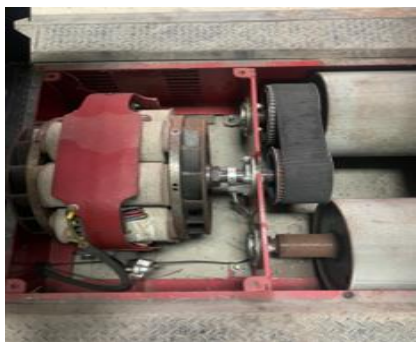
Hình 4. Mô tơ gây tải cho bộ thử
